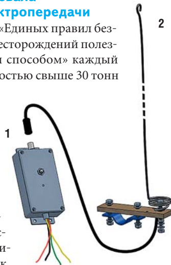
Устройства сигнализации приближения автосамосвала к воздушной линии электропередачи (УСПВЛ):
